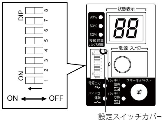
2. 設定スイッチ変更後、「電源」スイッチを押してから離して本機の電源を切り、AC 入力プラグを電源コンセント（商用電源）から抜きます。
