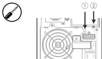
3. バッテリ接続ケーブルの固定金具を、BU100SW と BUM100S に取り付けます。
