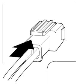
**4.** ファンを本体の収納口に装着し (①)、手順 1 で外したねじ (3 個) を取り付けます (②)。
