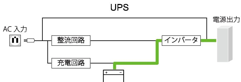
停電や入力電源異常が発生すると、商用電源からの電力供給が途絶えます。
