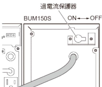
4. BU150SW の AC 入力プラグを、電源コンセント（商用電源）に差し込みます。
