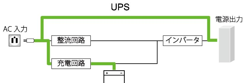
UPS 故障時などは、商用電源の電力をそのまま接続機器へ供給します。UPS のバッテリは充電されま
