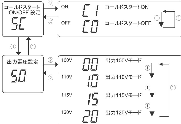
①：「ブザー停止/テスト」スイッチを短押し（3秒未満）して離すと状態表示が変わります。
