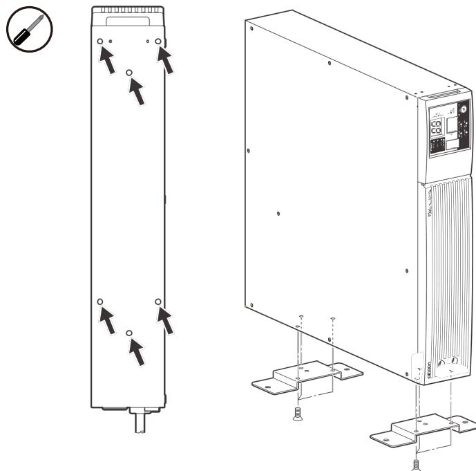
2. 本機を縦置きで設置します。
