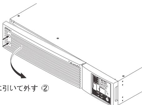
2. 板金カバーを固定しているねじ（2個）を外し（①）、板金カバーの右側を手前に引いて取り外します（②）。
