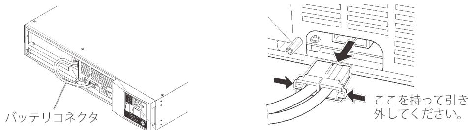
**4.** バッテリ前面にあるL字型の取手を持ち、手前に引っ張って取り出します。
