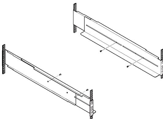
2. 取り付けるラックに合わせてラックレールの長さを調節し、手順1で仮止めしたねじをしっかりと固定します。
