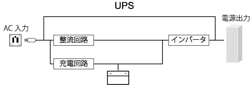
接続機器が多すぎたり、接続機器側の短絡故障が発生したりして、UPS が過電流を検知すると入力過電流保護器が動作します。
