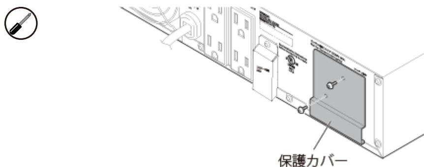
3. BUM100RE の背面から出ている接続ケーブルの保護キャップを外します。
