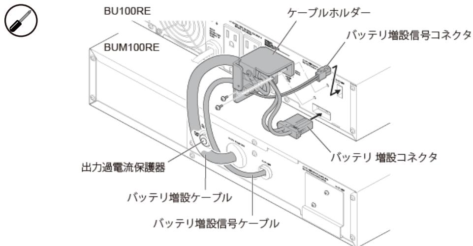
5. 手順 3 で外した保護キャップを BU100RE にねじ (M3) (1 本) で取り付けます。
