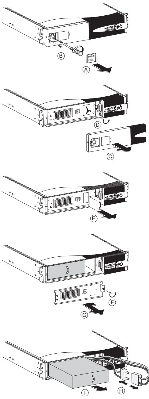
Ⓐ 左側の OMRON ロゴが印刷された四角いプレートをドライバのようなものでこじり取りはずす。
