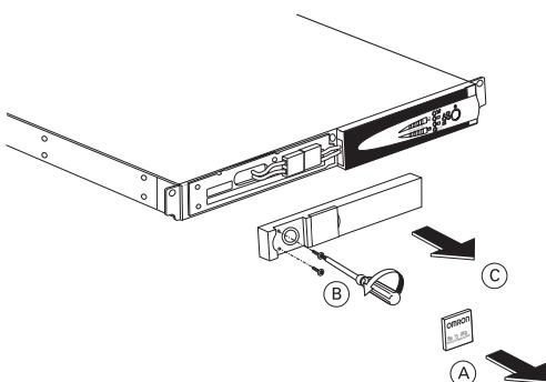
Ⓐ 左側の OMRON ロゴが印刷された四角いプレートをドライバのようなものでこじり取りはずす。
