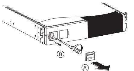
Ⓐ 左側の OMRON ロゴが印刷された四角いプレートをドライバのようなものでこじり取りはずす。
