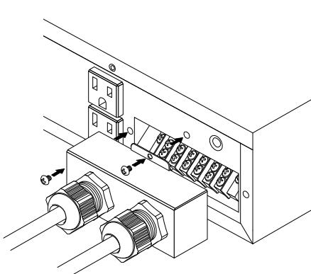
**5.** 入力ケーブルを配電盤などの商用電源に接続します。
