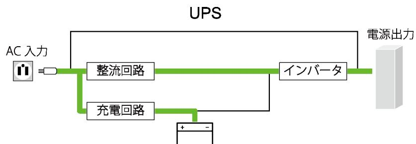
商用電源から UPS に電力が供給され、UPS のバッテリが充電されます。
