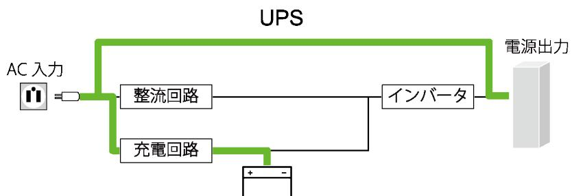
Eco モードは、商用電源の電力をそのまま接続機器へバイパス出力する低消費電力の運転状態です。
