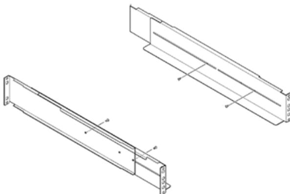
2. 取り付けるラックに合わせてラックレールの長さを調節し、手順1で仮止めしたねじをしっかりと固定します。
