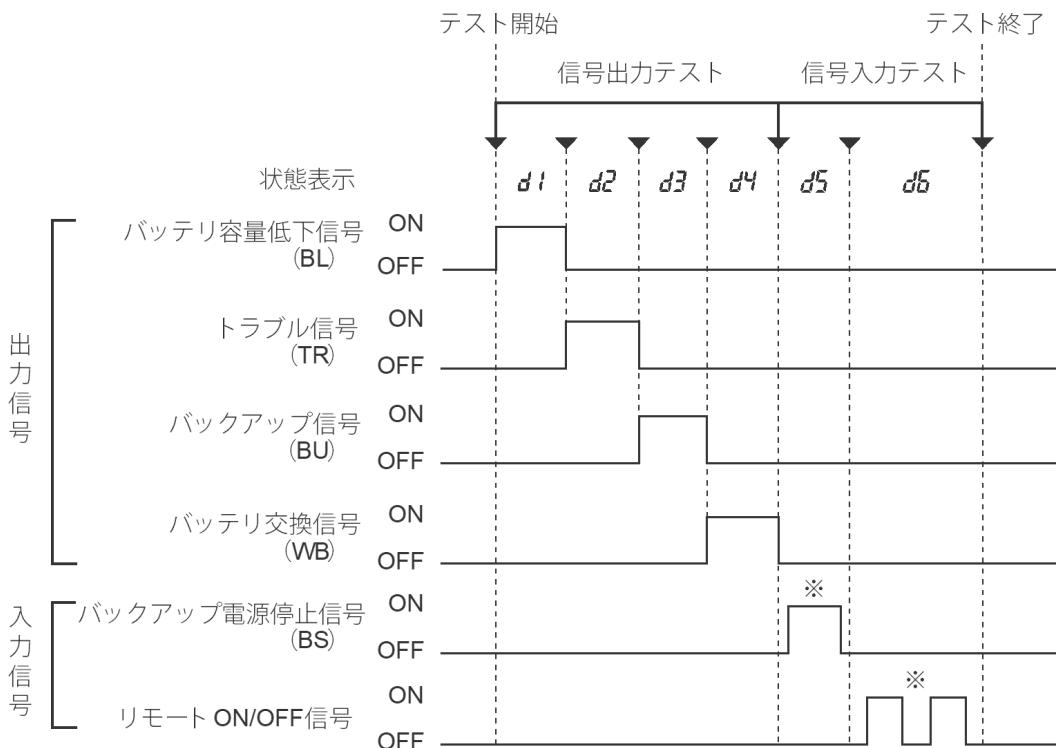
※ 信号入力テスト中は状態表示が点滅し、ブザーが鳴動します。
