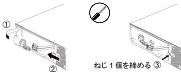
**7.** バッテリコネクタを止まるまで差し込み (①)、バッテリケーブルをケーブルホルダに取り付けます (②)。
