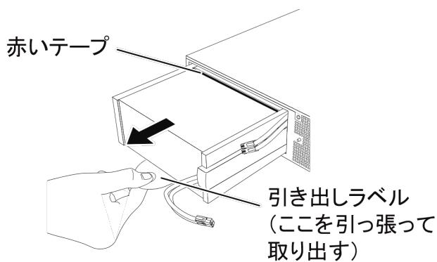
**5.** 新しいバッテリを本体の奥まで挿入し、収納します。
