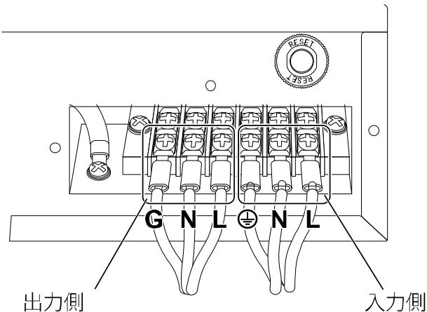
**4.** 端子台カバーをねじで固定し、クランプを回して電線を固定します。
