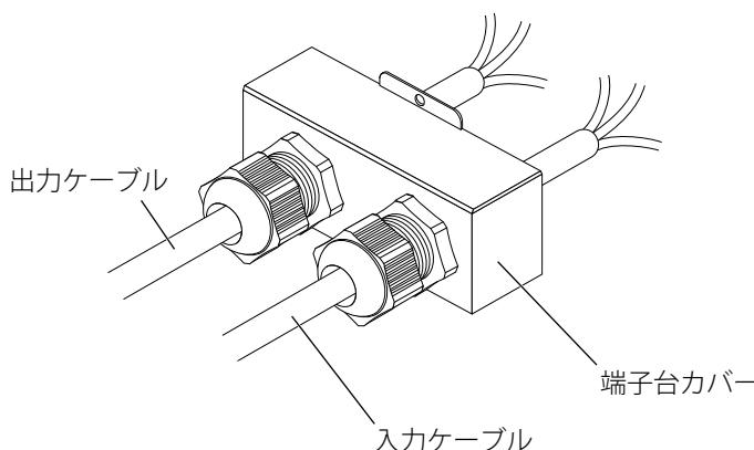
**2.** 出力端子台に出力ケーブルを取り付けます。
