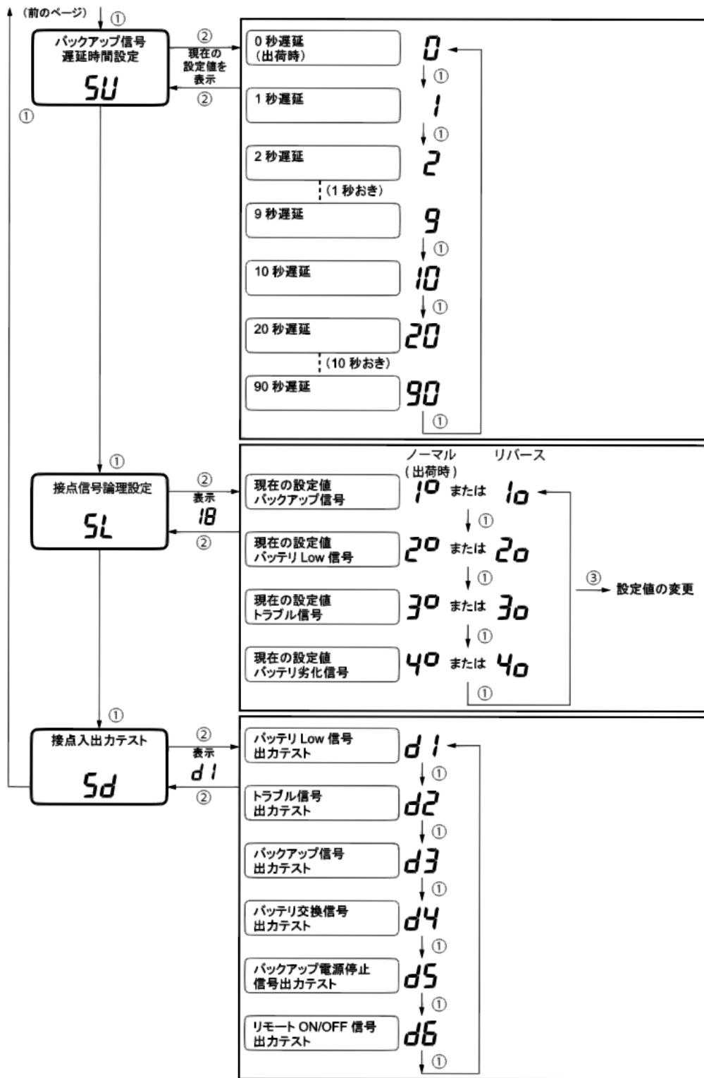
①: 「ブザー停止/テスト」スイッチを短押し（1秒以下）して離すと状態表示が変わります。
