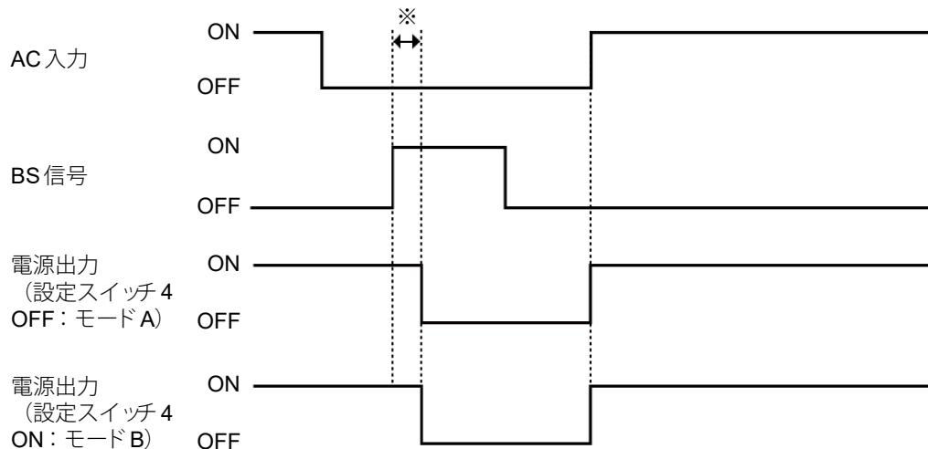
※ バックアップ電源停止信号（BS）受信から本機が停止するまでの時間です。出荷時の設定では 10 秒間となります。
