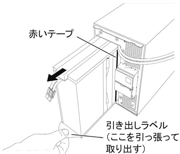
**5.** 新しいバッテリを本体の奥まで挿入し、収納します。
