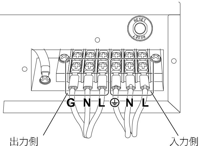
※ 入力端子台と出力端子台の G 端子は、本機の内部で接続されております。出力端子台の G 端子は接続機器用のため、AC 入力側のアース相とは接続しないでください。
