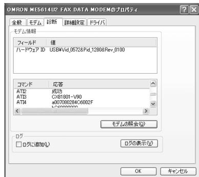
Windows Me/98SEの方は、[スタート]→[設定]→[コントロールパネル]→[モデム]の順にダブルクリックしてください。[検出結果]タブをクリックし、「OMRON ME5614U2 FAX DATA MODEM」が表示されているポートをクリックし、[詳細]または[詳細情報]をクリックすると確認できます。結果は④を参照してください。
