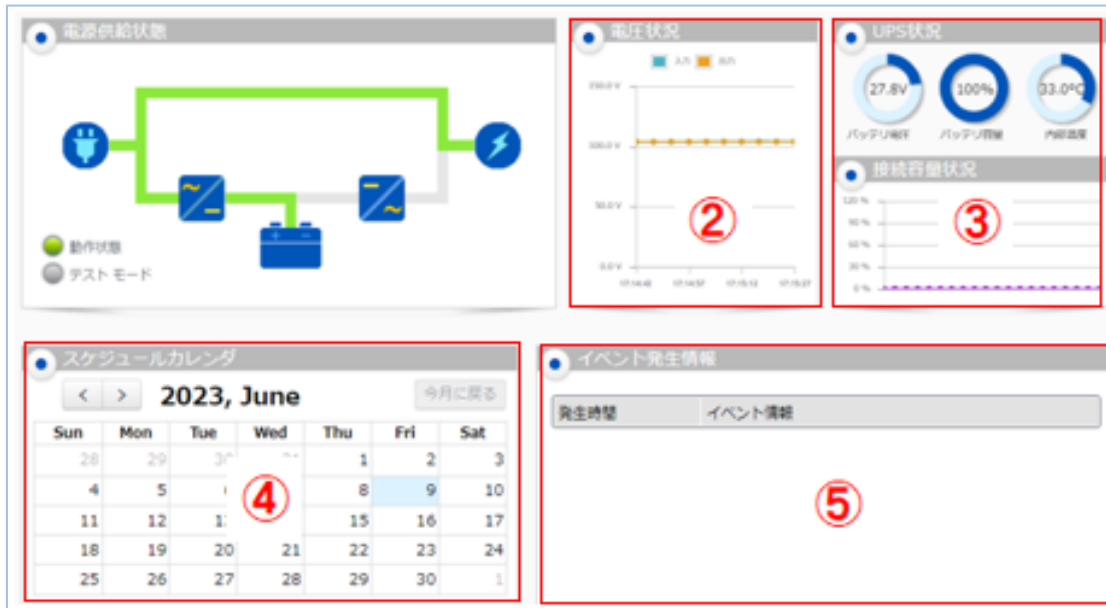
◆図2：電圧状況、UPS 状況、接続容量状況、スケジュールカレンダー、イベント発生情報
