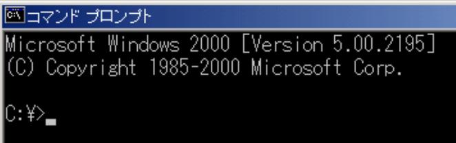
4 ネットワーク上にDHCPサーバがない場合、SNMP/Webカードは固有のIPアドレス、172.17.xxx.zzz を初期値とします。SNMP/Webカードの裏面ラベルに記載されているMACアドレスの下から2セットがxxx.zzzです。コマンドプロンプトで以下の通り入力してください。
