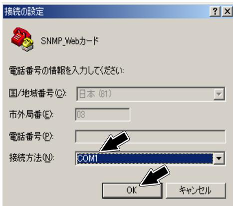
6 設定したCOMポートのプロパティを設定するための画面が表示されますので、以下のように設定してください。
