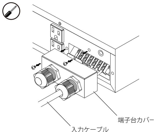
2. 出力ケーブル側のクランプに挿入されているキャップを外し、出力ケーブルを通します。
