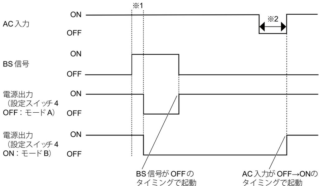
※1 バックアップ電源停止信号（BS）受信から本機が停止するまでの時間です。出荷時の設定では 10 秒間となります。
