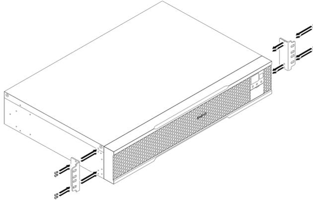
**2.** ラックの柱にめねじがない場合、ラック用ケージナット（M5）（8個）を取り付けます。
