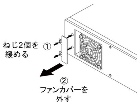
3. ファンを固定しているねじ（4個）を外し（①）、ファンガードを取り外します。ファンを手前に引っ張って取り出します（②）。
