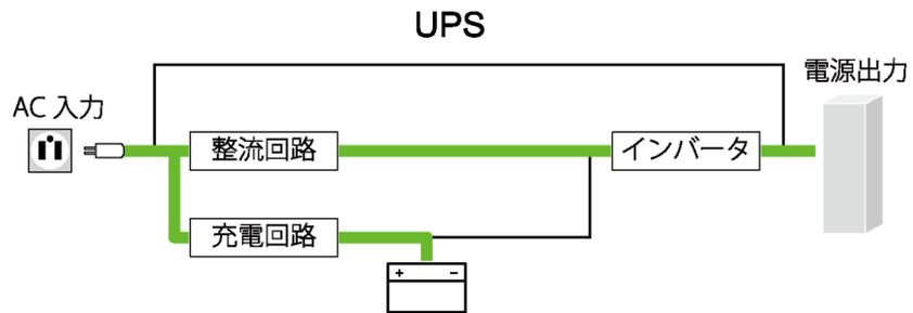
商用電源から UPS に電力が供給され、UPS のバッテリーが充電されます。
