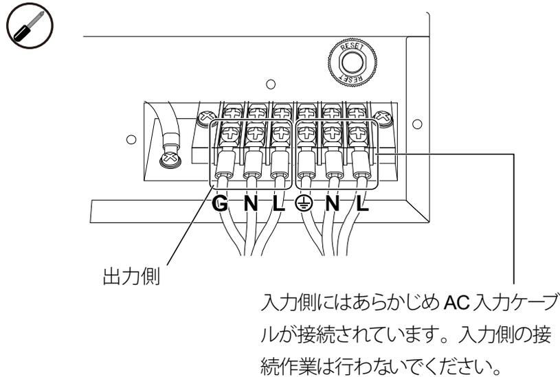
4. 端子台カバーをねじで固定し、クランプを回して電線を固定します。
