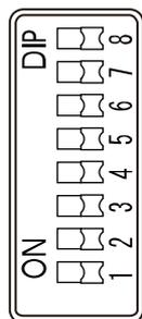
2. 設定スイッチ変更後、「電源」スイッチを押してから離して本機の電源を切り、AC 入力プラグを電源コンセント（商用電源）から抜きます。
