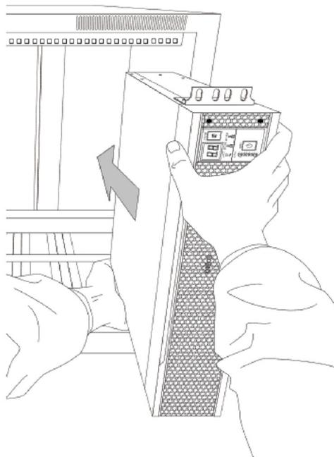
4. ラックの穴と耳金具の穴を合わせ、耳金具をラック取付けねじ（M5）（8本）でラックに固定します。
