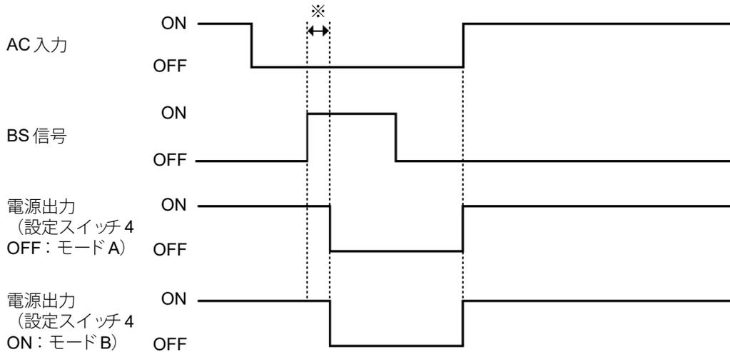
※ バックアップ電源停止信号（BS）受信から本機が停止するまでの時間です。出荷時の設定では 10 秒間となります。
