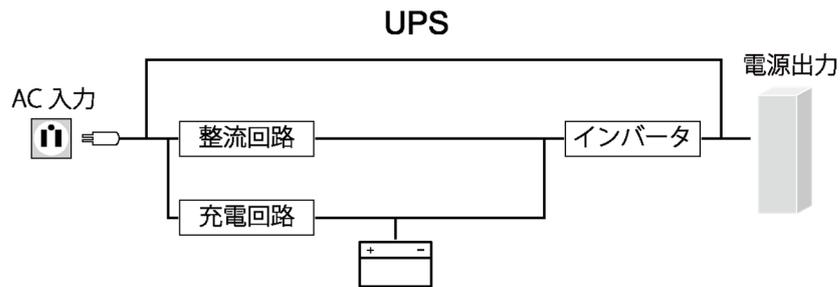
接続機器が多すぎたり、接続機器側の短絡故障が発生したりして、UPS が過電流を検知すると入力過電流保護器が動作します。
