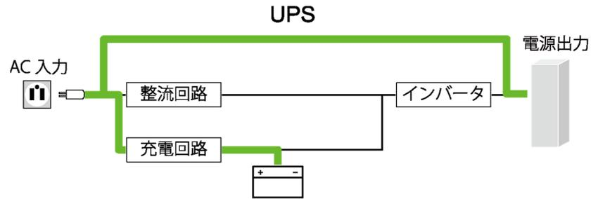
UPS 故障時などは、商用電源の電力をそのまま接続機器へ供給します。UPS のバッテリーは充電されません。
