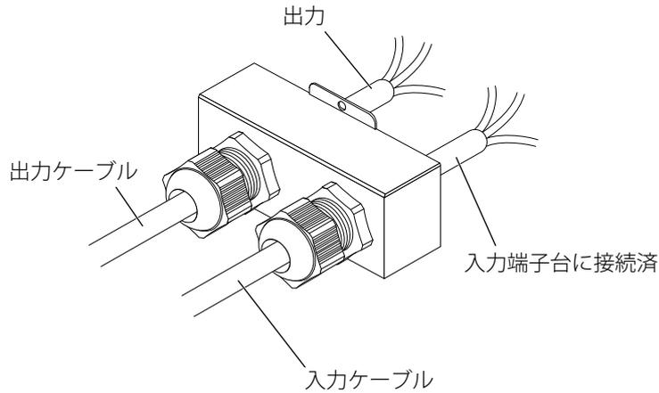
3. 出力端子台に出力ケーブルを取り付けます。
