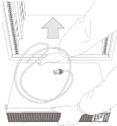
4. ラックの穴と耳金具の穴を合わせ、耳金具をラック取付けねじ（M5）（8本）でラックに固定します。
