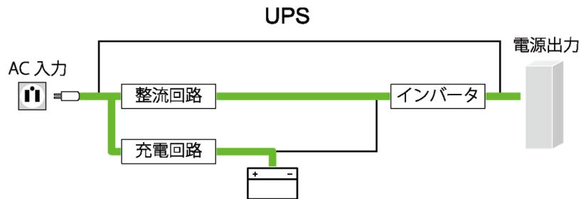
商用電源からの電力供給が再開すると、商用運転に戻ります。商用電源から UPS に電力が供給され、UPS のバッテリーが充電されます。
