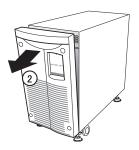
2. 板金カバーから上下のバッテリコネクタを取り出し(①)、それぞれのコネクタを引き外します(②)。
