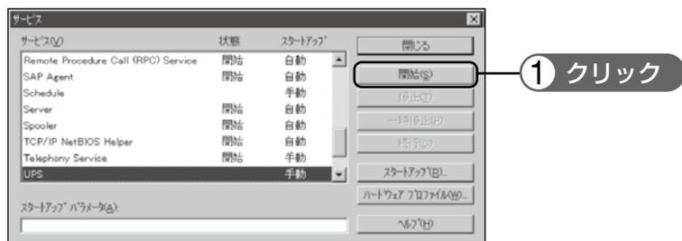
UPS サービスは、Alerter サービス、Messenger サービス、Event log サービスをあらかじめ開始しておくことで、停電などのイベント発生時にユーザー警告メッセージ、およびその履歴の記録を行えます。
