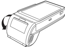
(2) 残っている伝票ロール紙を取り除き、新しいロール紙の先端を、開けたプリンタカバーから少し出るようにセットします。
